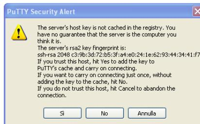
**Figura 4:** La finestra di dialogo del programma Putty con cui viene chiesta conferma della connessione con il server remoto
