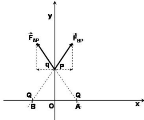
Come mostrato in figura, tali forze hanno la stessa proiezione sull'asse  $y$  e proiezioni uguali ed opposte sull'asse  $x$ . Da ciò segue che la forza elettrostatica totale è un vettore diretto lungo l'asse  $y$  di intensità pari alla somma delle componenti  $y$  di ciascuna forza:
